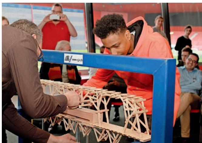
7 | Vorbereitung für den Bruchtest: Die Lehrlinge achten darauf, dass ihr Modell korrekt im Prüfstand montiert wird.
