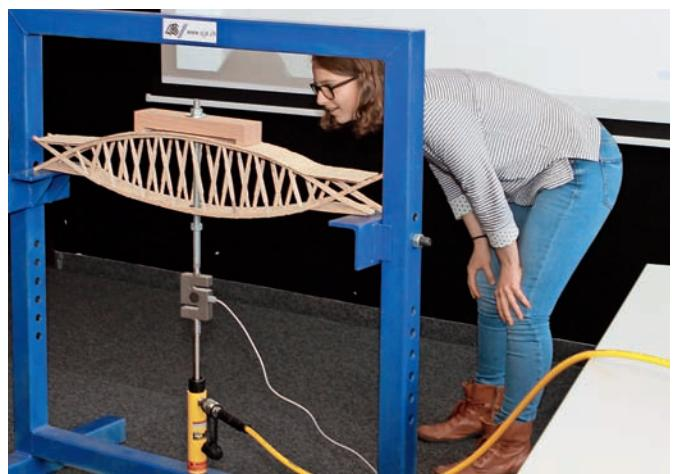
8 | Der spannende Moment: Auf dem Prüfstand wird die Modellbrücke solange belastet, bis sie bricht.
